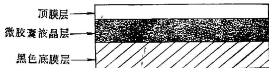
图3 微胶囊膜切面示意图
