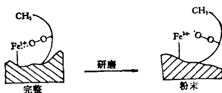
图 7 机械研磨对铁-氧复合物和不饱和脂肪酸之间分子联接的影响
